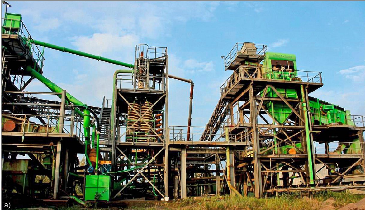
Abb. 3: Aufbau der Probenahme mittels Sortierspirale im Kieswerk 23/24
