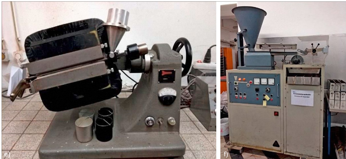
Abb. 8: Probenaufbereitung mittels Frantz-Magnetabscheider (e) und Korona-Walzenscheider (f) am Institut für Aufbereitung und Recycling der RWTH Aachen (IAR); (Fotos: PERSCHL 2018)
