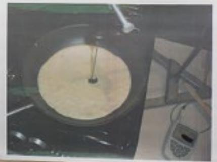
Pfannen: Mit der Hilfe von Stahlkugeln wird ein Abriebtest durchgeführt, um die Haltbarkeit der Beschichtung zu ermitteln.
