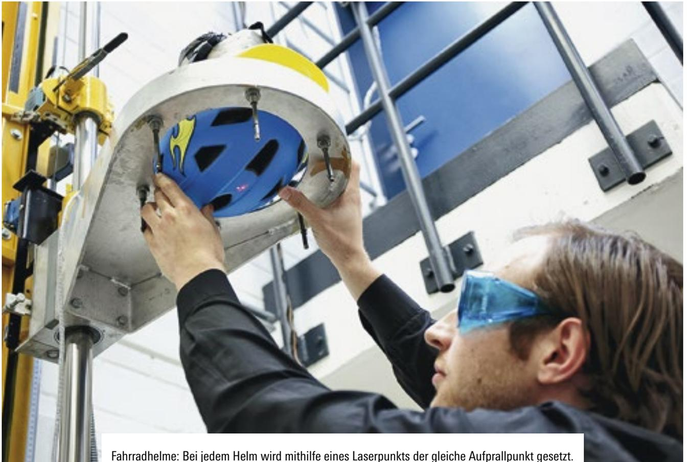
Fahrradhelme: Bei jedem Helm wird mithilfe eines Laserpunkts der gleiche Aufprallpunkt gesetzt. Mit einem Gewicht wird ermittelt, ob sich der Helm leicht vom Kopf streifen lässt.
