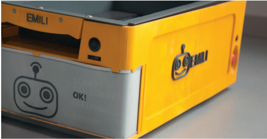
Abb. 2: Transportroboter EMILI teilt seinen Betriebszustand direkt auf einem Display mit.
