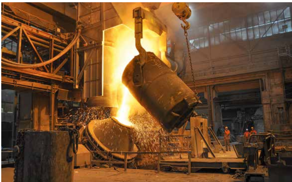
Abb. 10: Einfüllen der Vorschmelze in den AOD („argon-oxygen-decarburization“) -Konverter (Wiedergabe mit freundlicher Genehmigung der BGH Edelstahlwerke GmbH).
