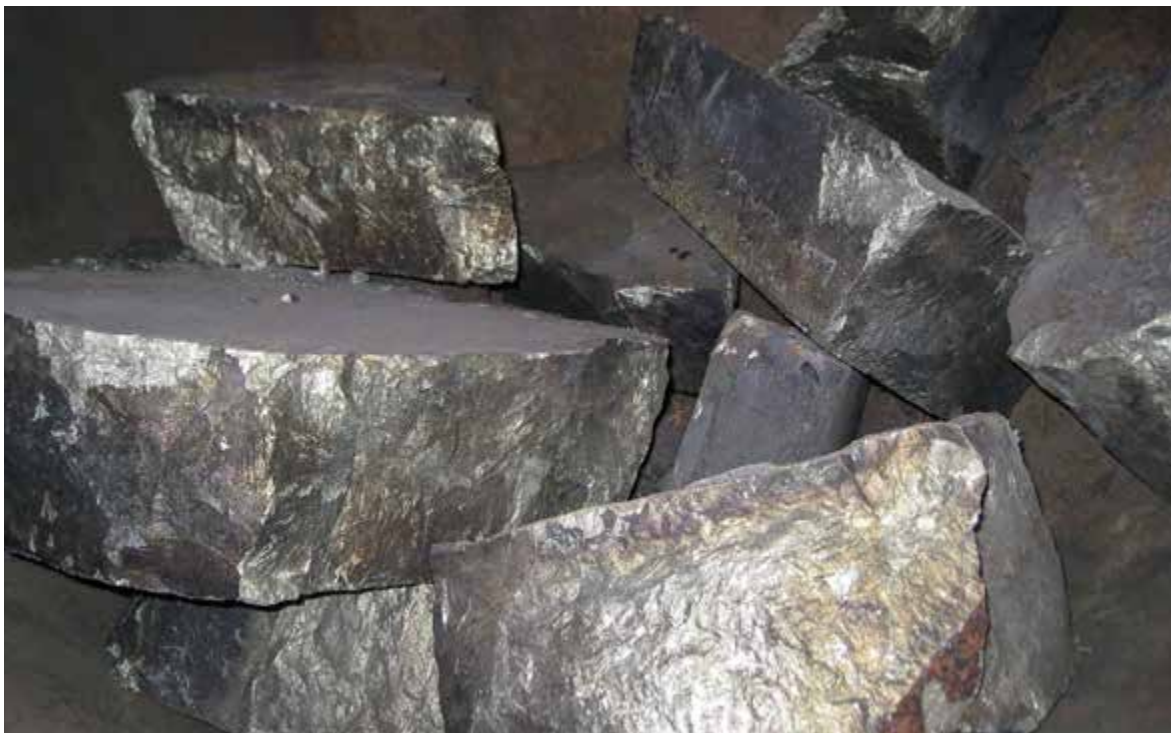
Abb. 32: Verkaufsfähige Nickelmatte vor der Zerkleinerung (Wiedergabe mit freundlicher Genehmigung der Nickelhütte Aue GmbH).
